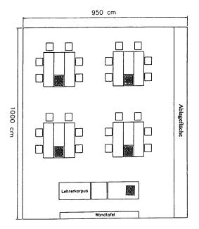
Die Energieblöcke (Fläche 60 x 60 cm) sind fest installiert und besitzen zwei Wasseranschlüsse, sechs Steckdosen zu 220 V sowie einen chemikalienbeständigen Ausguss. Die elektrische Spannung ist vom Korpus der Lehrperson aus schaltbar. Zusätzlich ist ein FI-Schutzschalter eingebaut. Im Korpus des Energieblockes wird allgemeines Material der Schüler/innen versorgt. Durch die fest installierten Energieblöcke ist die Anordnung der Tische und Stühle weitgehend vorgegeben.
