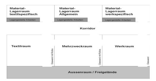
→ Werkraum und Textilraum je 50 m². Mehrzweckraum 100 m² mit Trennwänden, die zum Textil- bzw. Werkraum hin geöffnet werden können, um die Räume zu vergrössern.
