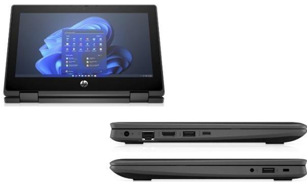
Das speziell für den Schulalltag hergestellte HP Pro x360 11 G11 EE verfügt nicht nur über einen gummierten Rand, sondern auch über eine Front- und Backkamera. Durch die x360 Funktion kann es ganz einfach von einem Notebook zu einem Tablet umgewandelt werden.
